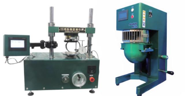
製品番号 KS-227 能力 50kN 土の一軸自動圧縮試験機
