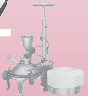
KA-69 加圧ろ過装置
